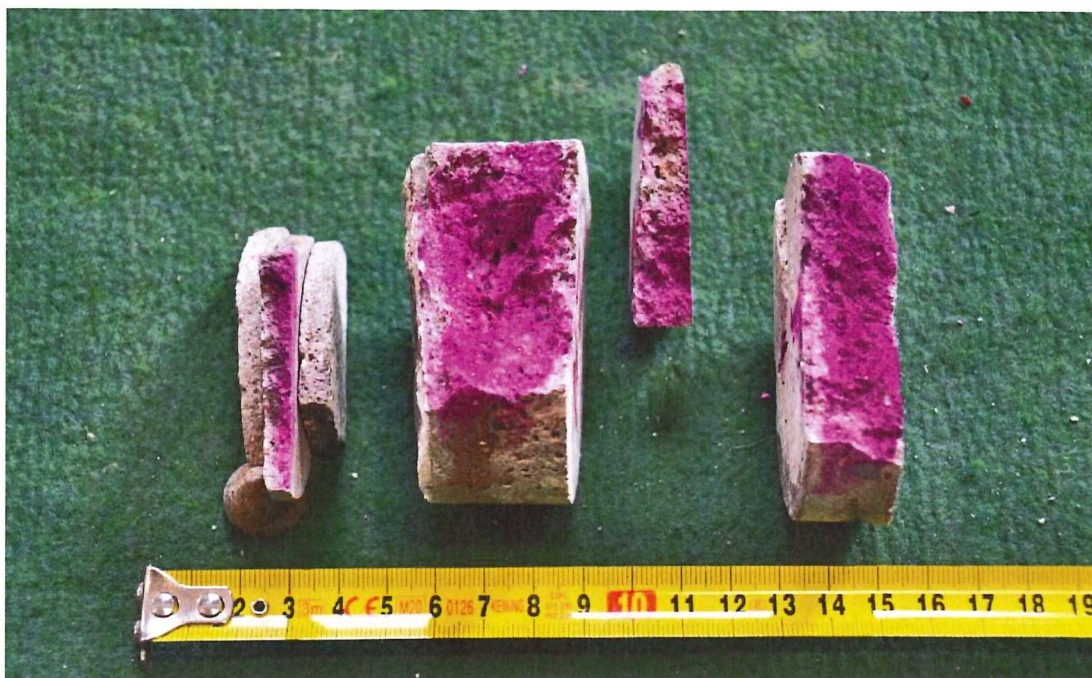
Obr. 2 Zkoušební vzorky po fenolftaleinovém testu hloubky karbonatace, která u všech těles dosáhla pouze cca 2-3 mm.
