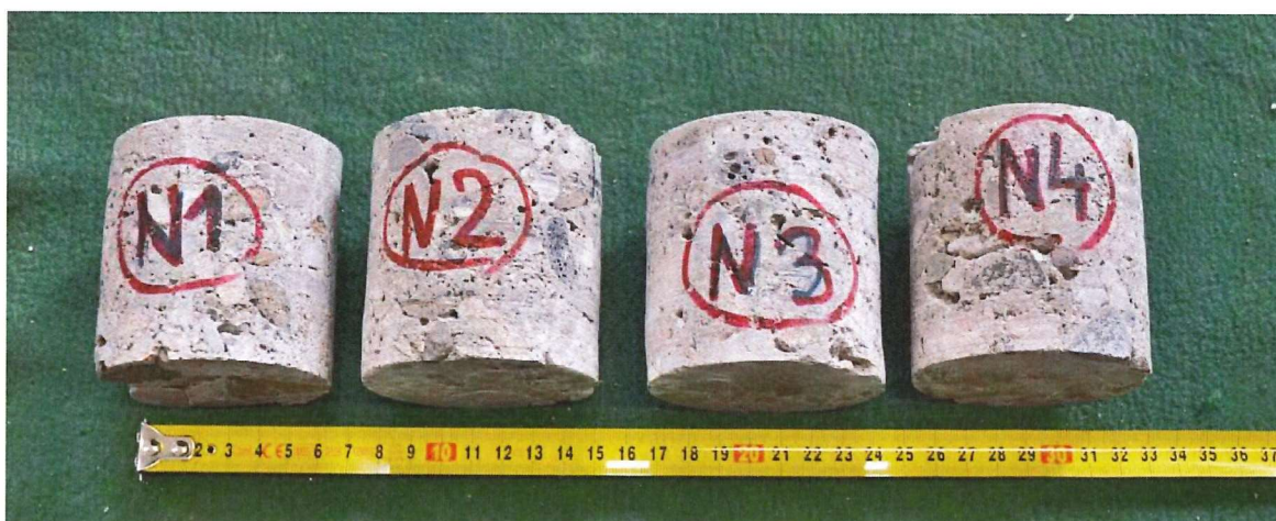
Obr. 3 Zkušební tělesa 1:1 vyrobená ze vzorků betonu N 1 až N 4.
