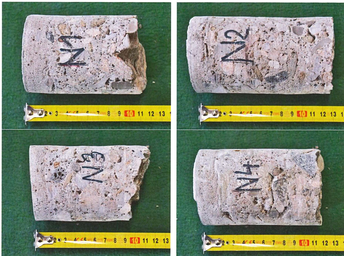
Obr. 1: Zkušební vzorky N 1 až N4 z balkonové desky balkonu. Na povrchu betonu je vrstva cementového potěru o tloušťce 10 -20 mm, ve vzorku N 2 je v hloubce cca 100 mm výztuž \varnothing 10 mm kruhová hladká.
